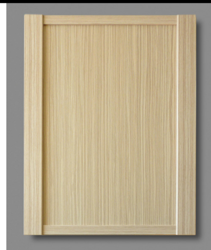
panneau mélaminé épaisseur 19 mm 4 chants arrondis épaisseur 2 mm PVC moulures en médium enrobées mélaminé
